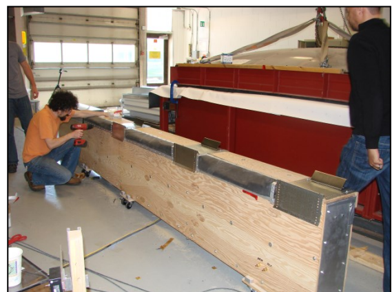
(d) Air sealing the pressure plane
