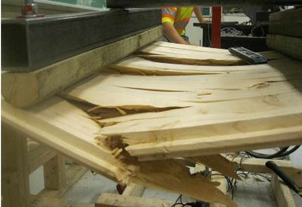
(d) 7 Board Failure
