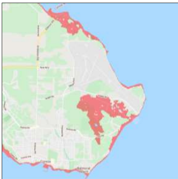
Figure 8. Élévation du niveau de la mer et risque d'inondations autour de la base aérienne Comox, selon le scénario RCP 4.5 (2080)
