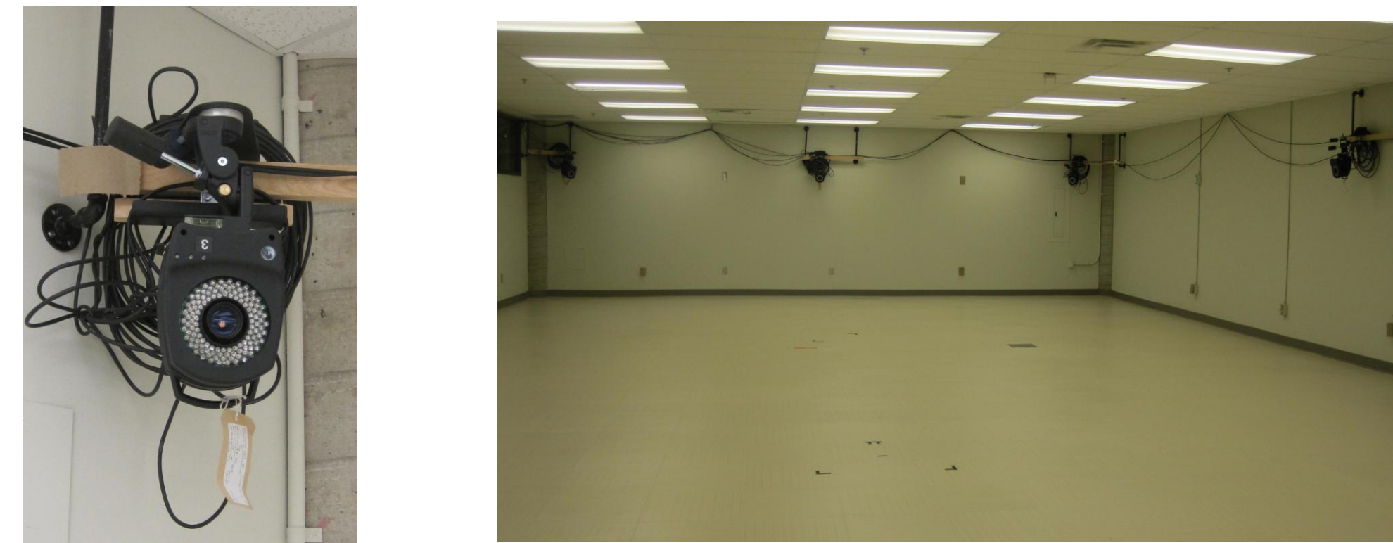
Figure 2. Le système VICON, qui consiste en huit caméras entourant l'espace d'expérimentation.
