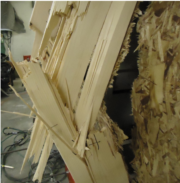
c) Stud 4 failure mode
