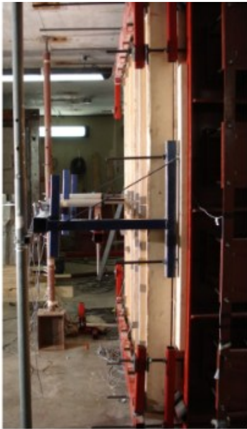
a) Stud wall before the test
