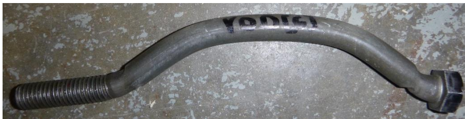
(d) Bending in bolt with no shear failure
