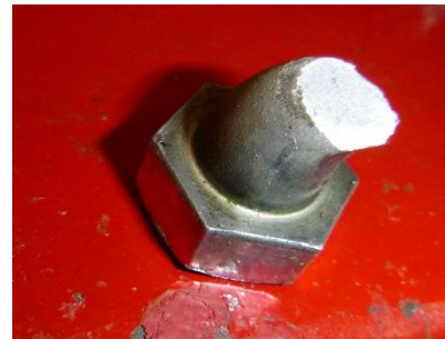
(d) Shear failure at bolt head
