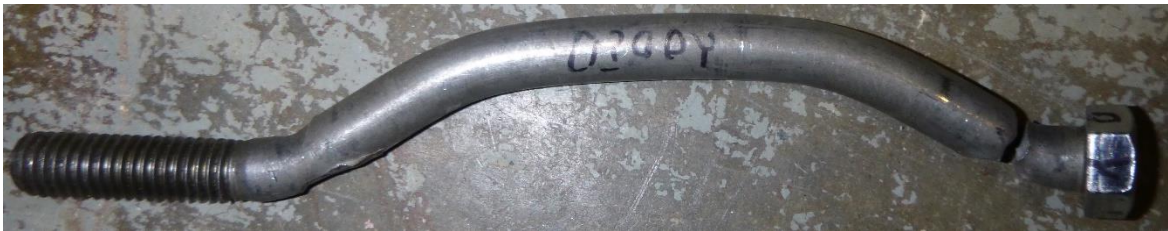
(d) Bending in bolt
