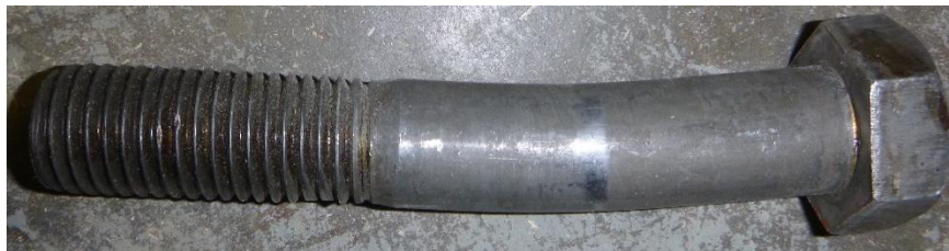
(d) Slight bending in bolt
