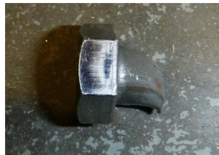
(d) Shear failure at bolt head
