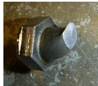
(d) Shear failure at bolt head
