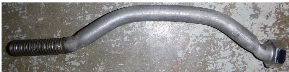
(d) Bending in bolt with no shear failure
