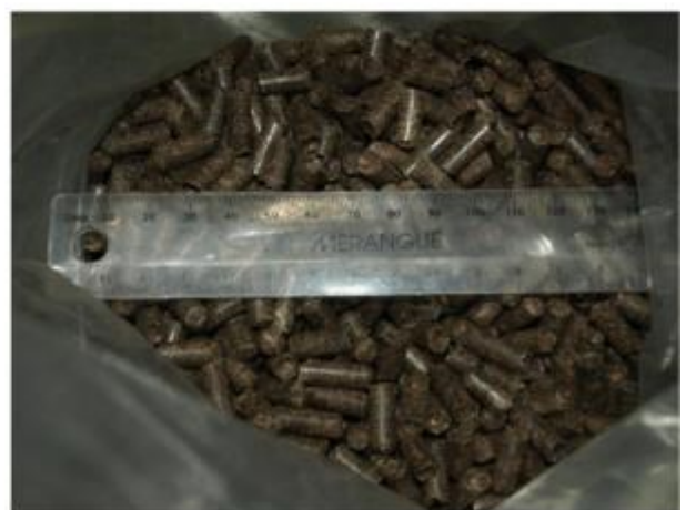
(D) Pellets: Produced using fines using a 6.35 mm (1/4") die
