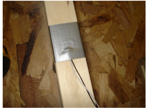
(d) Protection of strain gauge
