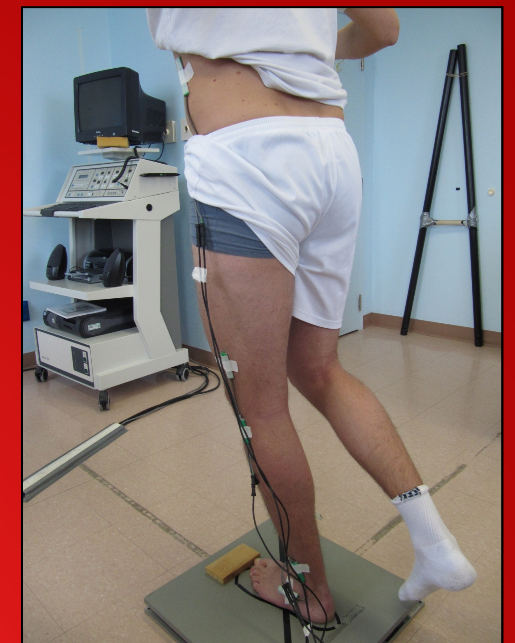
Figure 2. Sujet équipé des goniomètres.
