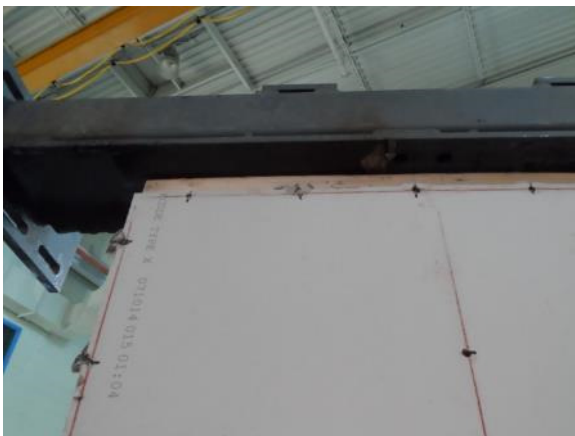
a) Top and Edge Pull-Through (Wall-5-1)
