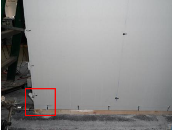
a) Side Edge Pull-Through Prior to Bottom Edge (Wall-6-1)
