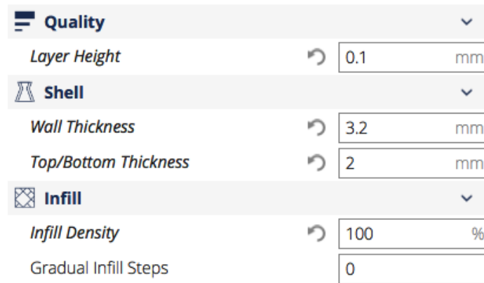
Figure 24 – Cura hinge print job parameter settings
