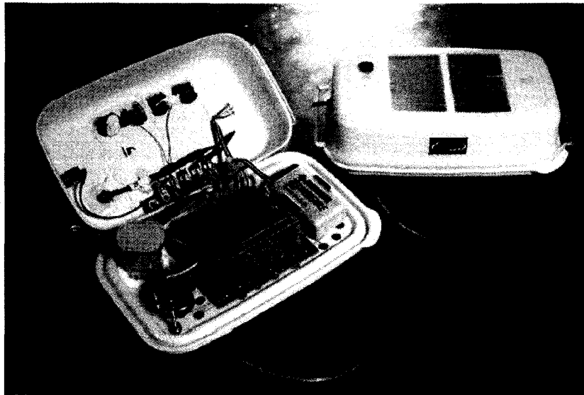
Figure 3.9: Prototype du capteur du Sensorweb 2. (Delin and Jackson, 2001).
