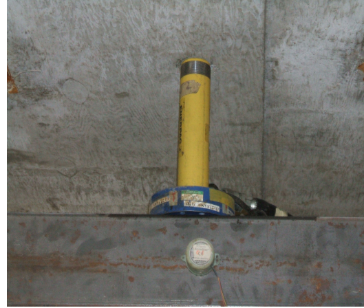
(d) Actuator Underneath Strong Concrete Floor
