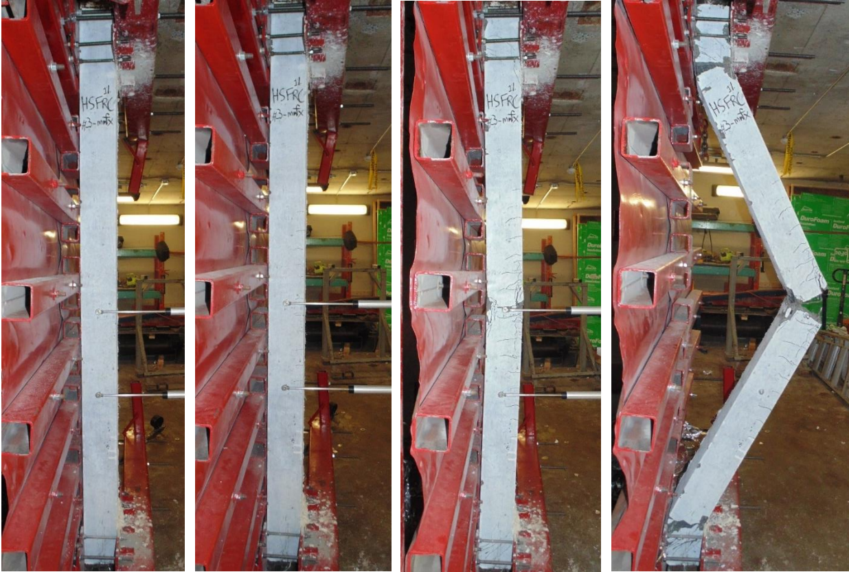
a) Blast 1 (17 psi) b) Blast 2 (35 psi) c) Blast 3 (80 psi) d) Blast 4 (100 psi)
