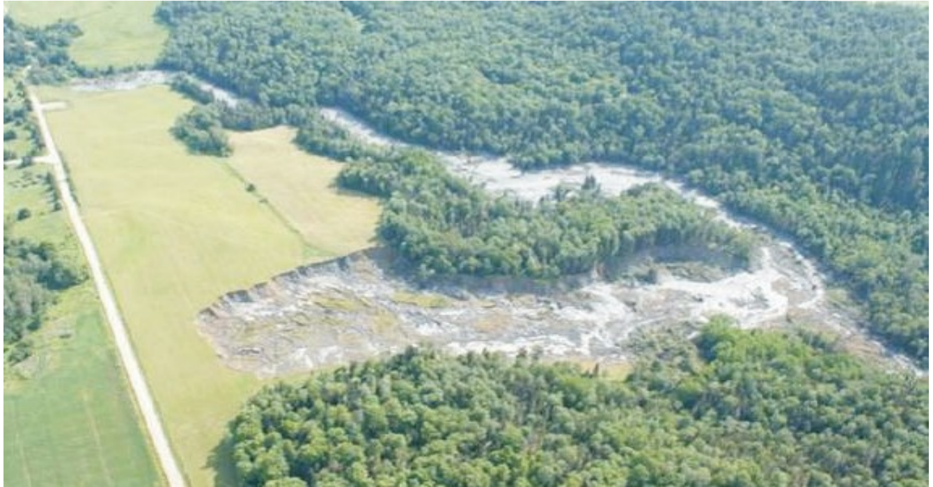
FIGURE 8.2: GLISSEMENT DE TERRAIN ROTATIONNEL CAUSÉ PAR UN TREMBLEMENT DE TERRE DANS LA RÉGION DE NOTRE-DAME DE LA SALETTE, QUÉBEC, CANADA (MINISTÈRE DES TRANSPORTS DU QUÉBEC). JUIN 2010
