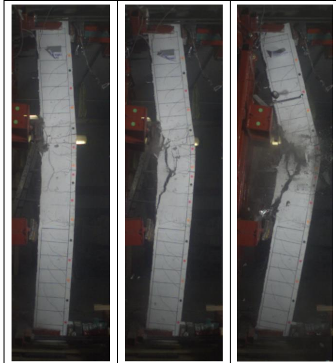
a) HSC-0.75%S1-20M-S Blast 3a (80 psi)
