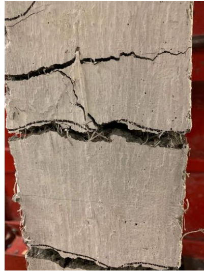
f) Fiber pullout (Blast 3b)
