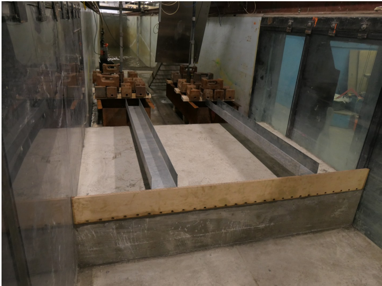
Fig. 3.2. Baseline vertical seawall case (TSAA)
