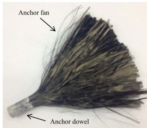
Fig. 2-5. Handmade FRP anchor fan (Zhang et al. 2017).
