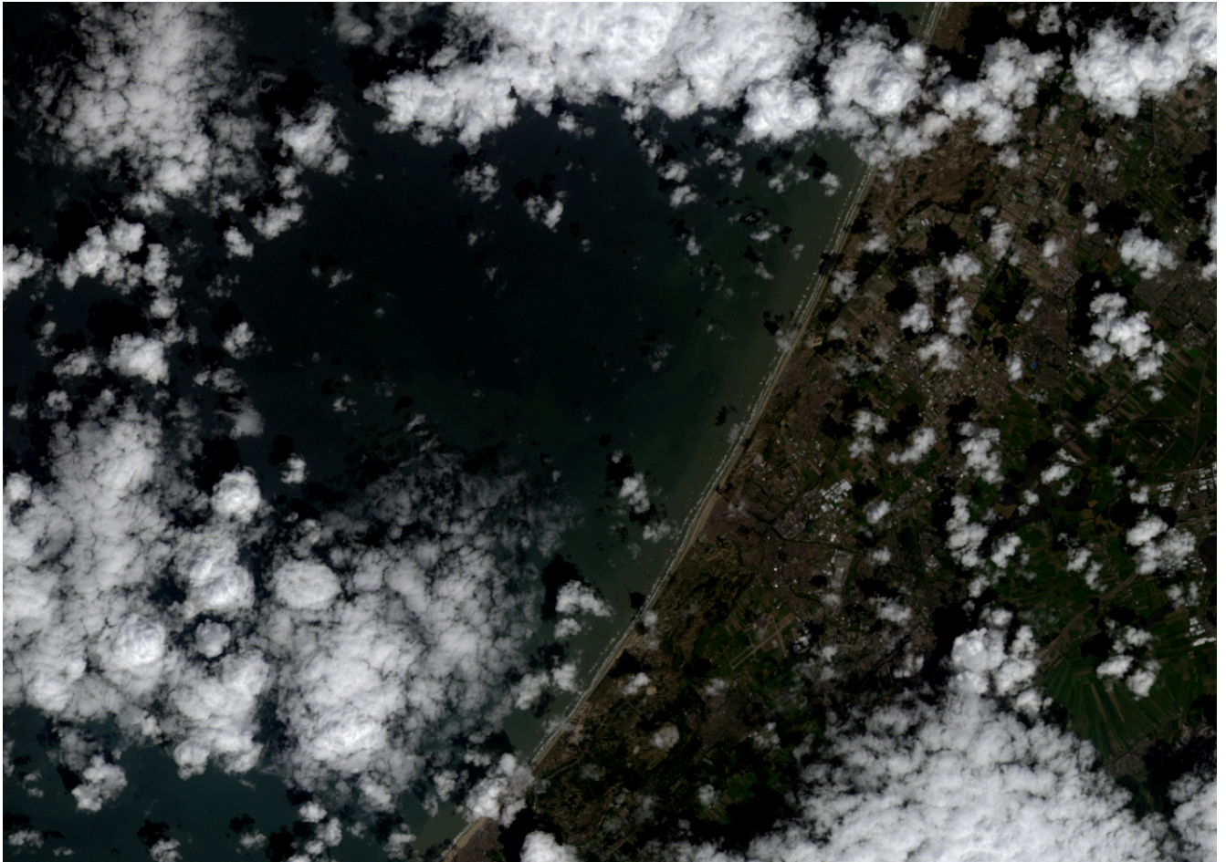
Figure 36: Renforcement linéaire du contraste en utilisant les valeurs minimales et maximales de l'image à la place de 50 et 240 dans l'exemple ci-dessus. Par Anders Knudby, CC BY 4.0.
