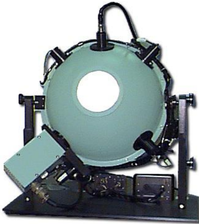
Figure 18: Sphère d'intégration utilisée pour l'étalonnage du capteur. Commercial Integrating Sphere par Electro Optical Industries, Wikimedia Commons, CC BY-SA 3.0.
