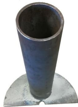
(D) Photo of compaction tank
