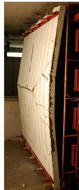
(d) After shot 3 P_r = 100.6 \text{ kPa} I_r = 811.2 \text{ kPa-ms}
