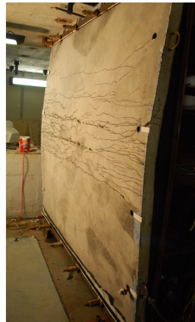
(d) After shot 4 P_r = 99.3 \text{ kPa} I_r = 2535.0 \text{ kPa-ms}
