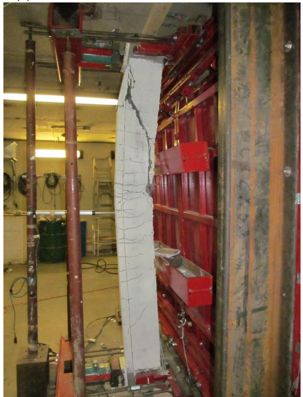
(d) SCC 0.5% 5D shear failure at Blast 4
