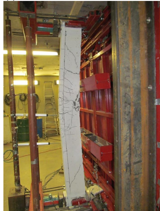
(d) SCC 0.75% BP flexural failure at Blast 4
