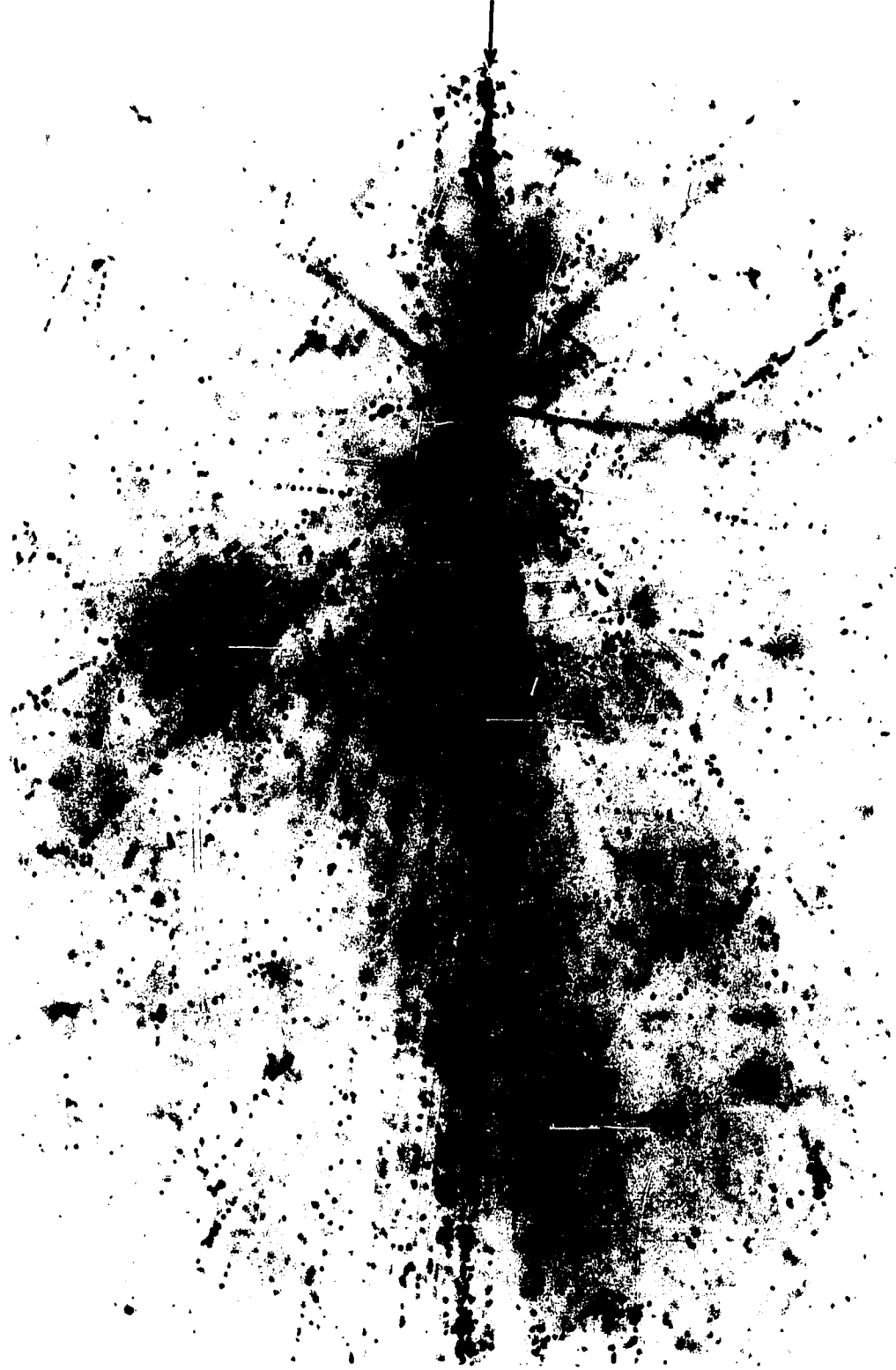
Photomicrographie d'une collision d'un noyau de Br avec un noyau de Mn pénétrant par le haut dans une émulsion de type Ilford G.5.
