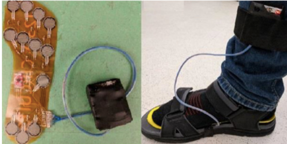
Figure 4. (Gauche) la semelle du CPS avec 12 capteurs de force alimenté par une batterie dans l'étui de caoutchouc externe. (Droite) La semelle placée dans la sandale d'un participant et la batterie attachée à la région crurale du participant.
