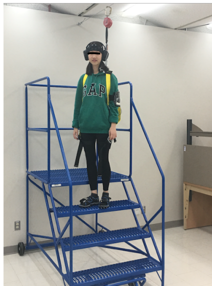
Figure 3. Un membre du laboratoire debout sur le montage d'escaliers en portant le casque sans fils, le bandeau fNIRS , le microphone sur le 'avant-bras, le harnais de sécurité et le système d'analyse de marche portable aux pieds.
