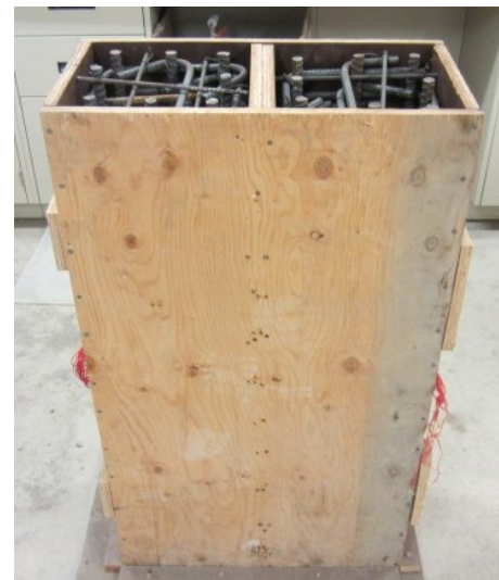
(d) UHPFRC Specimens in Formwork (Side View)
