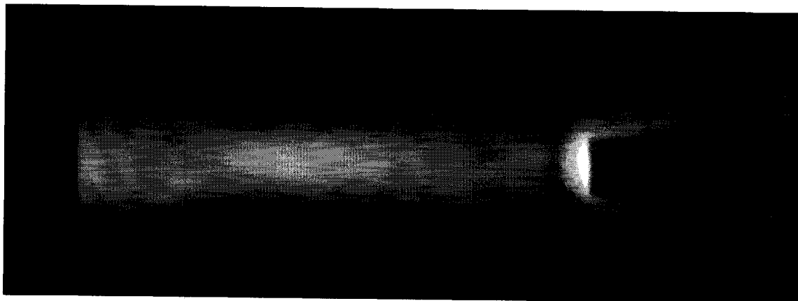
FIG. 5.14 – Mesure du jet supersonique par l'insertion de la sonde d'enthalpie (sonde B de la figure 5.3) à 35 mm du plan de sortie de la torche, sur l'axe du jet.
