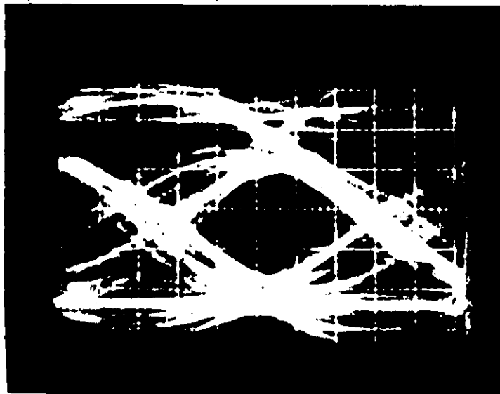
Figure 7.5: Signal télétexte binaire transmis à 8 Mb/s. en bande de base.
