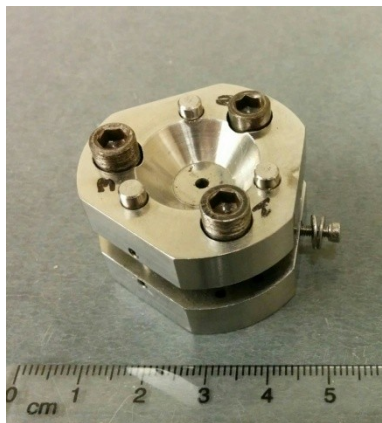
Figure 3.2 : Photo d'une CED à trois tiges de coulissement. Ce concept de cellule fut développé en 1974 [16]. Les trois tiges verticales servent pour l'alignement et le déplacement des moitiés. L'ouverture centrale procure un accès optique à l'échantillon comprimé.
