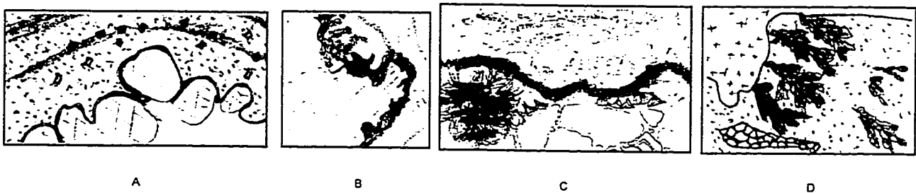
FIGURE 6.29 SCHÉMAS MONTRANT DES CARACTÉRISTIQUES DE LA SUBSTANCE INCONNUE. A: GAINE ENTOURANT DES CRISTAUX DE LA ROCHE SOUS-JACENTE (MKZI 2-A) B: STRATE AU CONTACT DE LA ROCHE SOUS-JACENTE (ÎLE 2-D) C: STRATE AU CONTACT DE LA ROCHE SOUS-JACENTE ET FORMATIONS FIBREUSES TRÈS COMPACTES (FLÈCHES) (CASC 1-A) D: FORMATIONS DENDRITIQUES (MINE 2-F)
