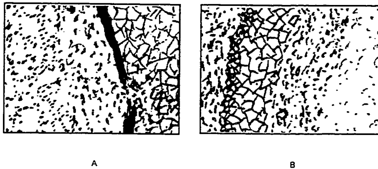
FIGURE 6.27 SCHÉMAS DES ZONES DE CONTACT ENTRE LES MICRO-STRUCTURES COMPOSANT L'ÉCHANTILLON WSON 5-A, A: DÉMONTRANT UNE DISCONTINUITÉ ENTRE LES PÉTRO-STRUCTURES ET B: LES ZONES DE TRANSITION OBSERVÉES DANS UNE AUTRE SECTION DE LA LAME
