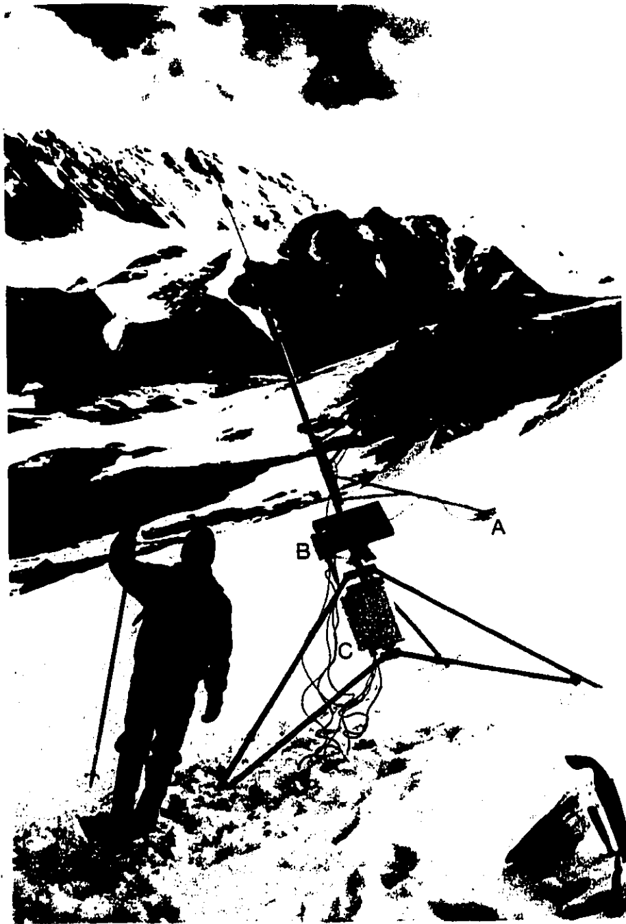
Figure 17 Position des instruments de mesure sur la tour portative (A: Pyranomètre réfléchi et incident; B: sonde de température et d'humidité relative; C: enregistreur de données Campbell 21X).
