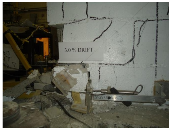
(d) Crushing of east end; 3.0% drift
