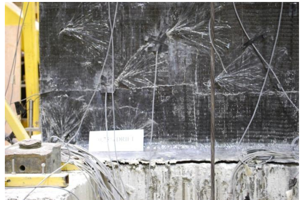
(d) Separation of FRP at 0.5% drift
