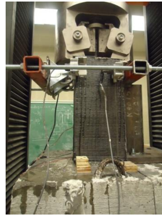
(d) Block sample ready for testing
