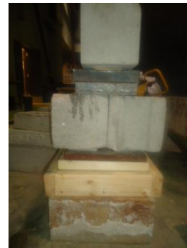
(d) Weights to clamp the layers
