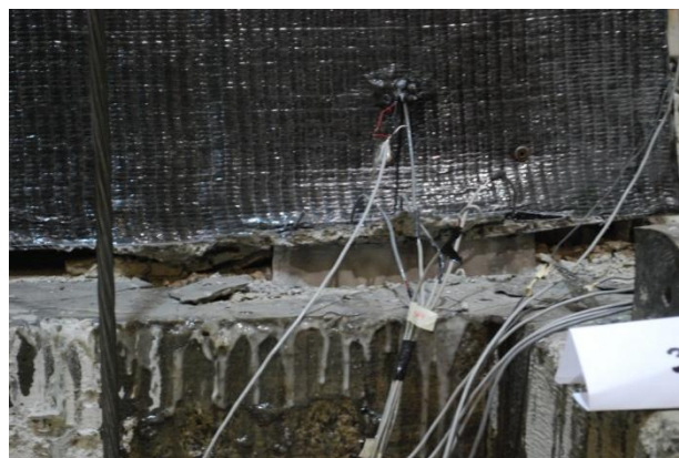
(d) Wall-foundation interface; 3.0% drift
