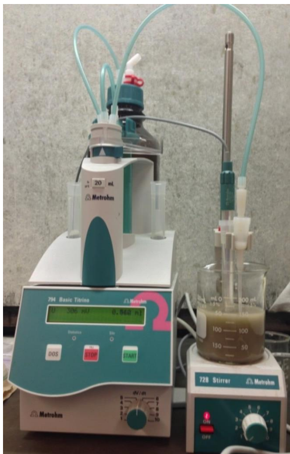
Figure 3.35: 794 Basic Titrino automatic potentiometric titrator
