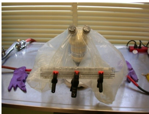
Figure 3.10: Sac à gants étanche utilisé pour le chargement de l'I 2 . Deux embouts sont connectés à l'extérieur, l'un pour le pompage de l'air à l'intérieur du sac, et l'autre pour le remplissage du sac par un gaz inerte. Afin de faciliter la manipulation d'échantillons à l'intérieur, le manipulateur s'équipe de gants en latex. Étant donné la présence de neige carbonique à l'intérieur, on doit évacuer une certaine quantité de gaz en cas d'une trop grande dilatation du sac.
