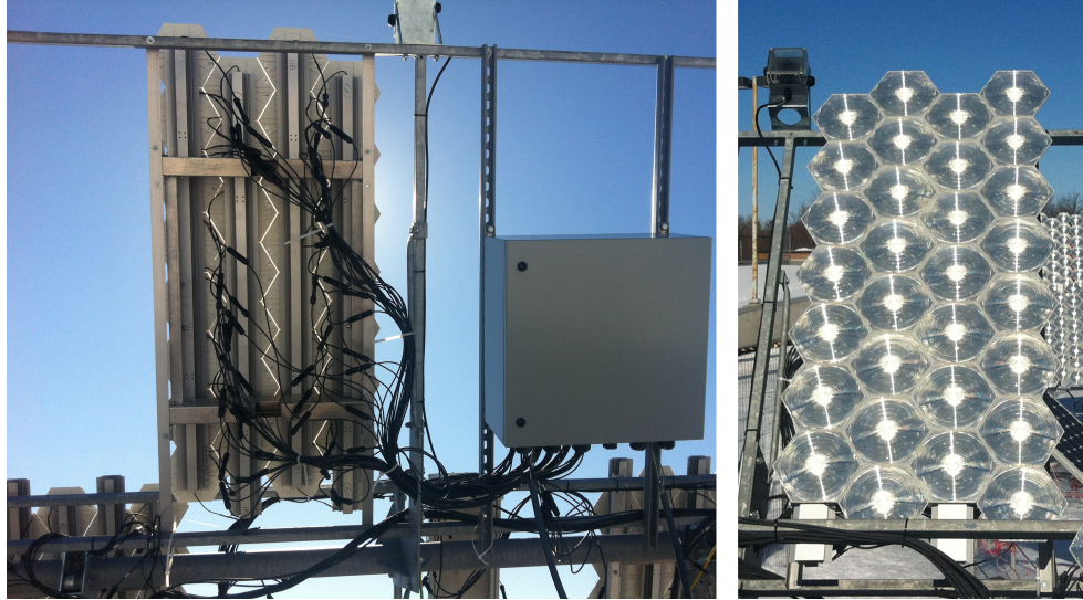
FIGURE 3.8 – Panneau prototype : photo 1 (à gauche) - vue de derrière et photo 2 (à droite) - vue de devant. On voit chacune des 30 cellules connectées individuellement par des câbles PV, qui eux vont se connecter dans la boîte grise présentée (la boîte contenant l'unité multiplexeur) dans la photo de droite. Ce panneau est installé au site de tests de l'Université d'Ottawa
