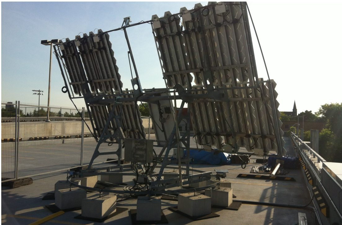
FIGURE 3.6 – Le suiveur solaire Golden Sun GS3500 du site de tests de l'Université d'Ottawa est ici présenté. On remarque la grande surface disponible pour l'installation de panneaux solaires.
