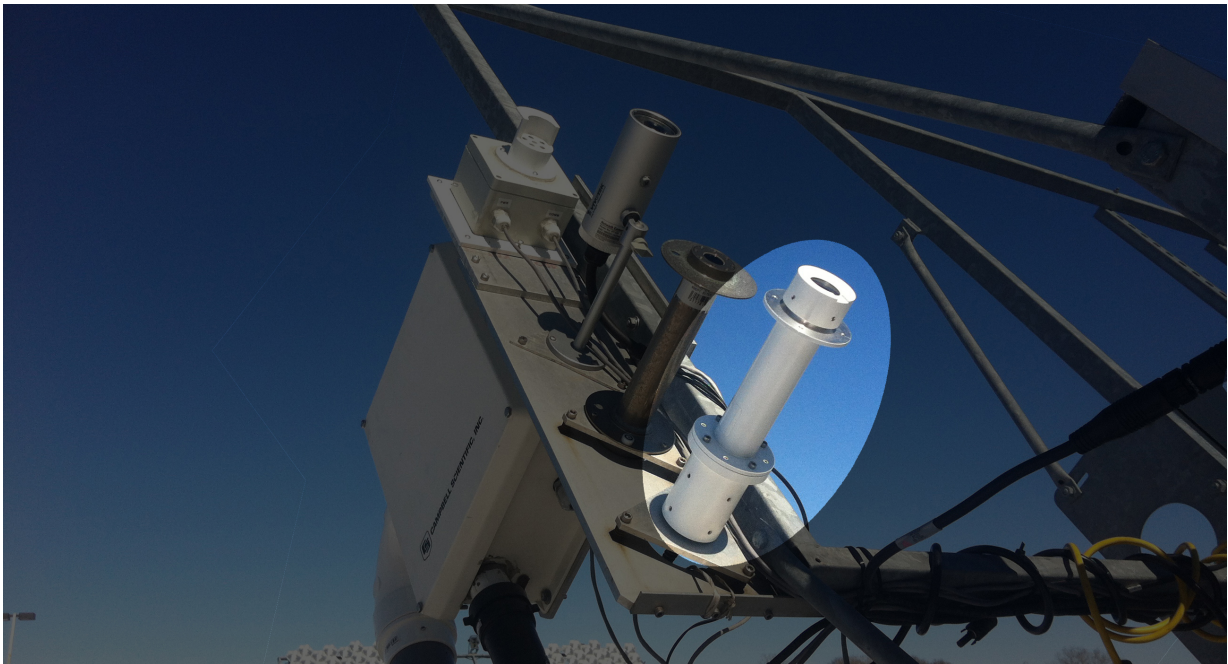
FIGURE 3.5 – Le tube de collimation du spectroradiomètre du site de tests de l'Université d'Ottawa permet à seulement la lumière perpendiculaire directe du soleil d'être mesurée par l'instrument.
