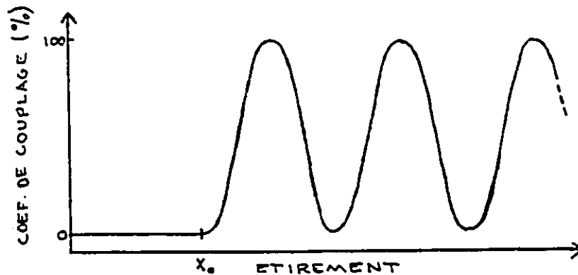
Fig. 3.16: Evolution théorique du coefficient de couplage en fonction de l'étirement
