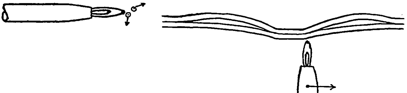
Fig. 4.8: Exemples de situations découlant de tensions inégales dans les fibres
